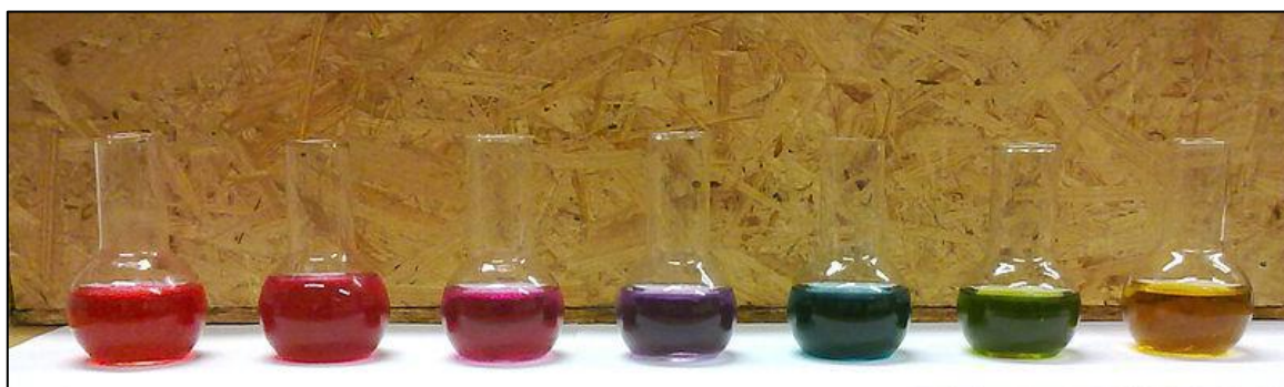
Figura 2 - Extrato de repolho roxo como indicador natural de pH. Observar a variação de cor (soluções ácidas adquirem um tom avermelhado e básicas um tom esverdeado).
