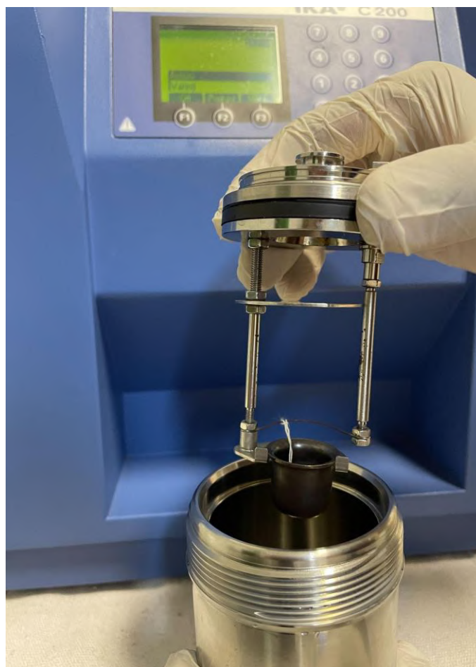
Figura 2 - Análise da amostra de lodo de esgoto na bomba calorimétrica.
